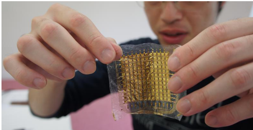
薄くて柔らかい有機デバイス技術を用いて、スリム化した薄膜皮膚センサ
