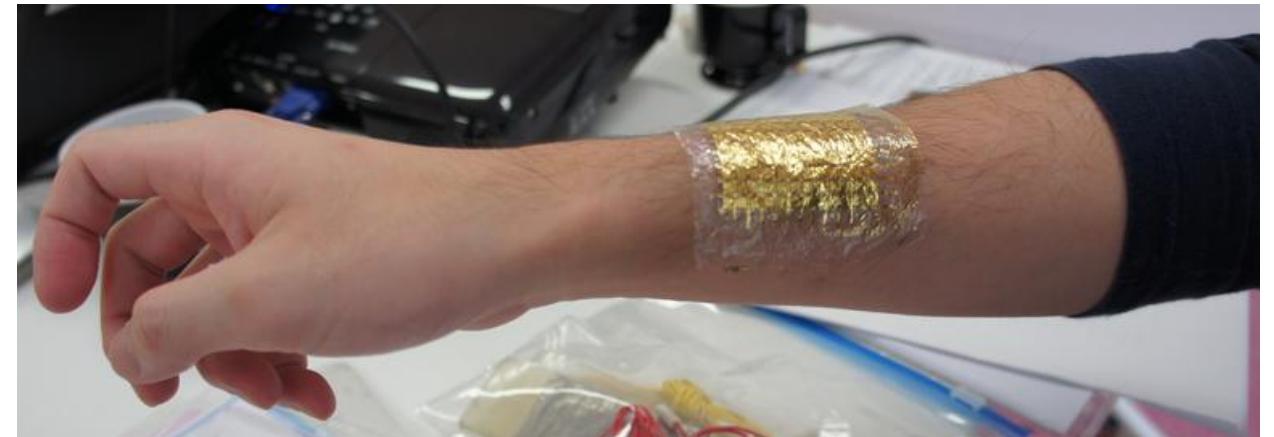
薄くて柔らかい有機デバイス技術を用いて、スリム化した薄膜皮膚センサ
